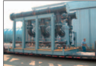
带三台 6.18 DN 400型波尔自动滤器的喷射水过滤单元
